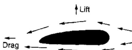
Figura 21. La forma del asa da como resultado la elevación a medida que el aire fluye sobre ella. (Fuente: Sistemas de energía renovable y eficiente por Gilbert Masters)
