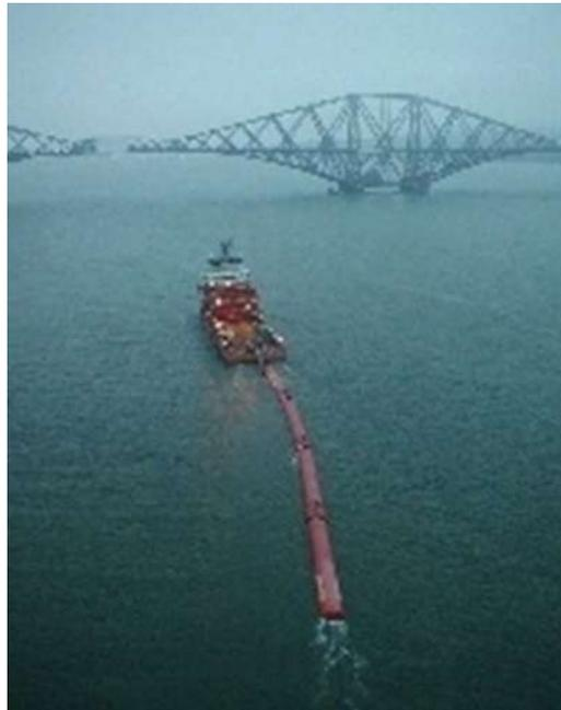
Figura 32. Prototipo de un generador de ondas Pelamis.
