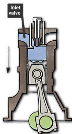
Figura 7. Figura que muestra un pistón acoplado al cigüeñal de un motor diésel
