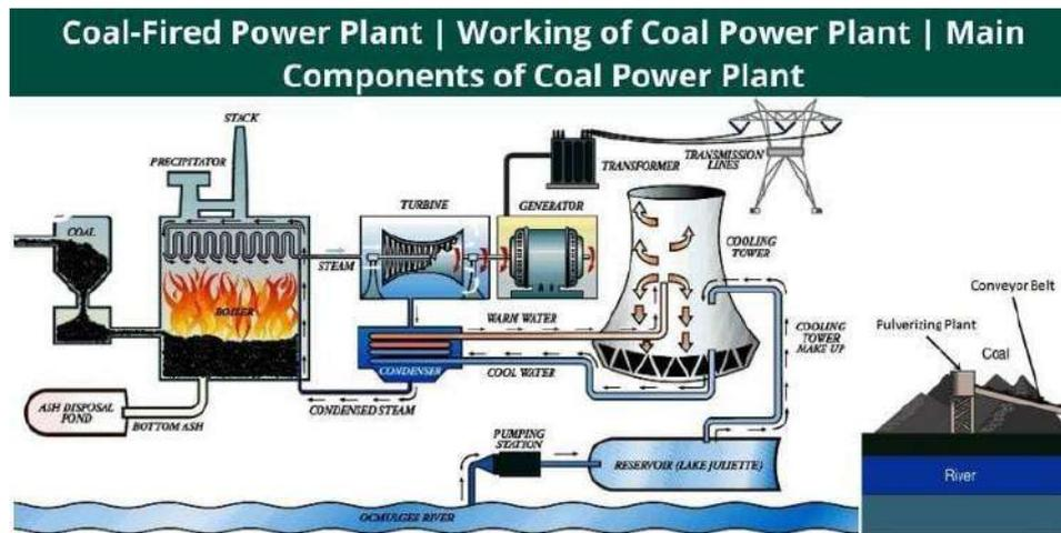
Figura 6. Diagrama de una central eléctrica de carbón
