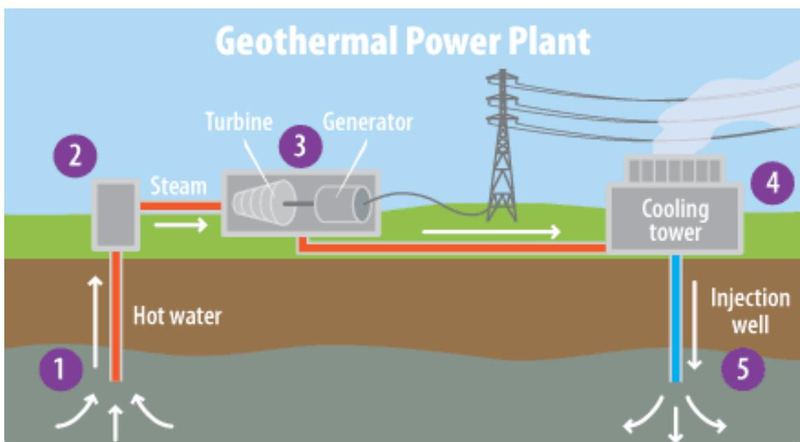
Figura 34. Diagrama que muestra el funcionamiento de una planta de energía geotérmica. (Fuente: <https://archive.epa.gov/climatechange/kids/solutions/technologies/geothermal.html>)
