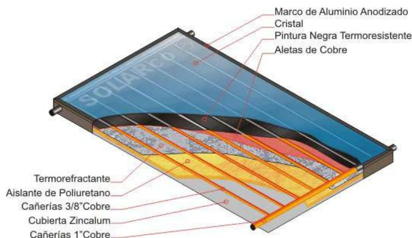
Figura 15. Componentes de un panel solar térmico.
