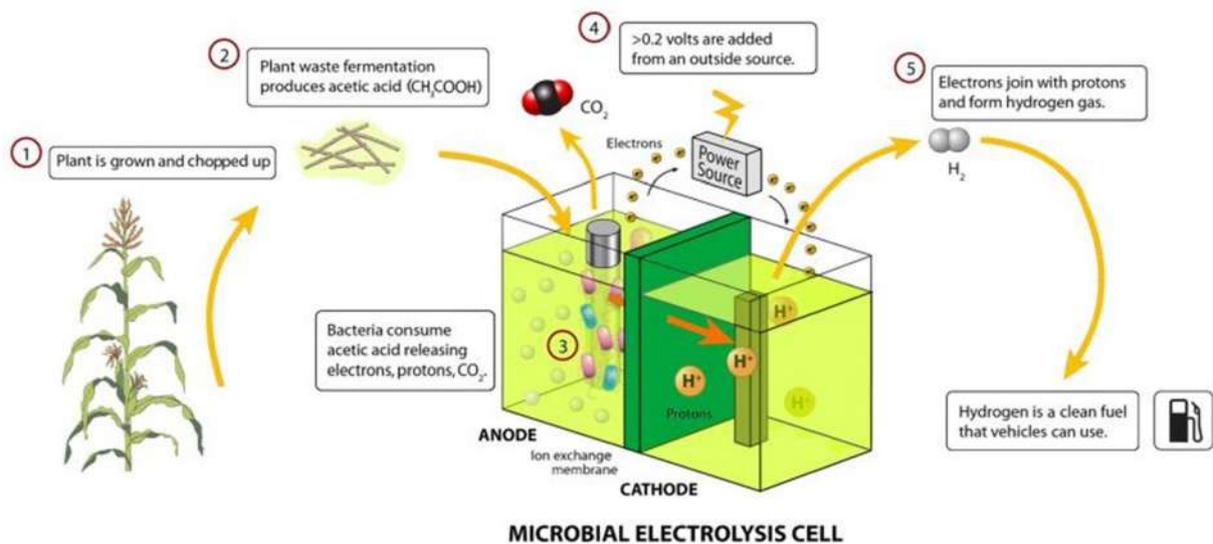
Figura 25. Conversión de residuos vegetales en gas hidrógeno.
