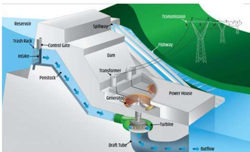
Figura 27. Diagrama que muestra cómo funciona una central hidroeléctrica.
