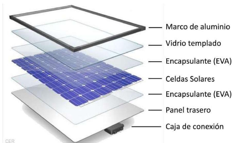
Figura 18. Estructura de un panel solar.
