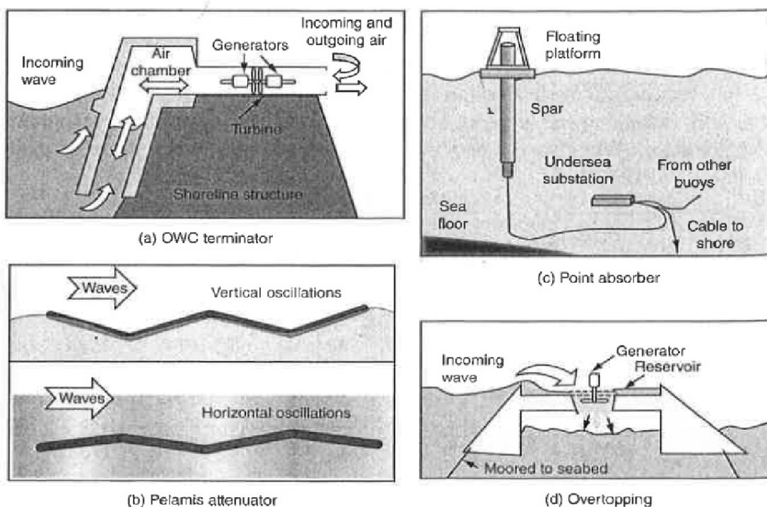
Figura 30. Cuatro tipos diferentes de convertidores de energía undimotriz (Fuente: Efficient and Renewable Energy Systems, Gilbert Masters)
